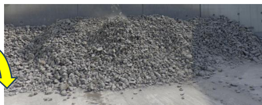
土木資材へ再資源化
